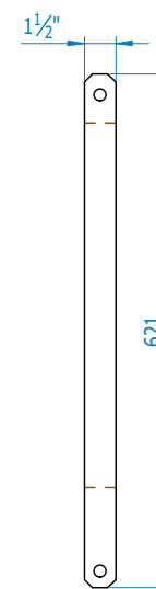
PT001 Material: ASTM A-36 PT 3/8" x 1 1/2" x 621 mm Cantidad : 02 Pzas. *01-Pza. Izquierda *01-Pza. Derecha Escala: 1 : 5
